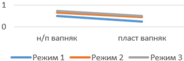
Рисунок 1 – Залежність В/Т-відношення від дисперсності вапняку в пластифікованих та неластифікованих системах.
