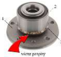
Рисунок 3 – Приклад застосування старого розрізного кільця:
