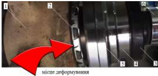
Рисунок 1 – Процес установки підшипника маточини колеса:
