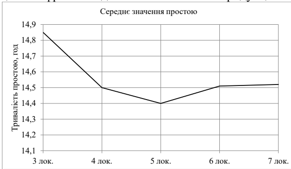
Рисунок 2 – Графік залежності тривалості простою вагонів від кількості використовуваних локомотивів
