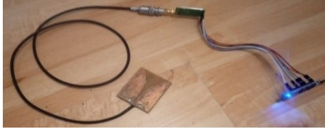
Рисунок 3 – Макет антени Вівальді на підкладинці 1,5 мм з текстоліту FR4
