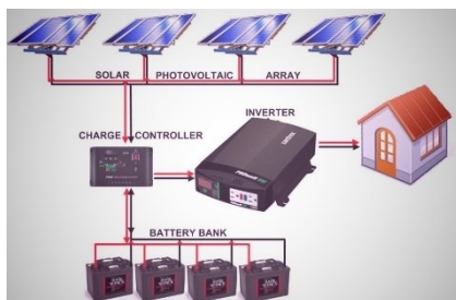
Рисунок 1 – Елементи та схема з'єднання індивідуальної сонячної електричної станції
