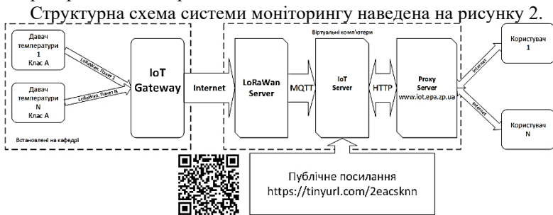
Рисунок 2 – Структурна схема системи моніторингу.
